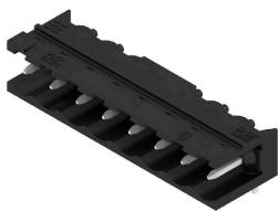
Термостойкий открытый штекерный соединитель угловой конфигурации (90°). Упаковка — коробка или лента. На ленте и с выводами под пайку 1,5 мм оптимизирован для автоматического монтажа. Длина выводов 3,2 мм подходит для пайки волной припоя и оплавлением сквозных отверстий (Reflow). Штекерные соединители обеспечивают место для маркировки и допускают кодирование. HC = сильноточный.
