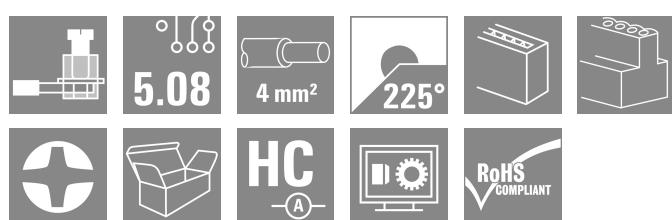
Соединение с зажимным хомутом и направлением выводов под прямым (90° или 270°) или тупым (225°) углом. Гнездовые разъемы обеспечивают место для маркировки и допускают кодирование. Крепление осуществляется с помощью фланца или фиксатора. Кроме того, они оснащены встроенным винтом с двумя шлицами (прямым и крестообразным), защитой от неправильной вставки провода и поставляются с открытыми зажимными хомутами. НС = сильноточный.
