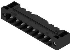
Термостойкий штекерный соединитель, упаковка — коробка или лента. На ленте и с выводами под пайку 1,5 мм оптимизирован для автоматического монтажа. Длина выводов 3,2 мм подходит для пайки волной припоя и оплавлением сквозных отверстий (Reflow). Штекерные соединители обеспечивают место для маркировки и допускают кодирование. HC = сильноточный.
