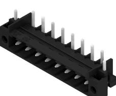
Термостойкий открытый штекерный соединитель прямой конфигурации. Упаковка — коробка или лента. На ленте и с выводами под пайку 1,5 мм оптимизирован для автоматического монтажа. Длина выводов 3,2 мм подходит для пайки волной припоя и оплавлением сквозных отверстий (Reflow). Штекерные соединители обеспечивают место для маркировки и допускают кодирование. HC = сильноточный.
