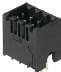
Термостойкий двухрядный штекерный соединитель для всех распространенных методов пайки. Оптимизирован для автоматического монтажа. Упаковка — коробка или лента. Длина выводов 3,2 мм, подходит для пайки волной припоя и оплавлением сквозных отверстий (Reflow). Штекерные разъемы обеспечивают место для маркировки и допускают кодирование.
