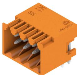
Угловой двухрядный вилочный разъем в следующих исполнениях: боковая сторона закрыта или с фланцем (вилочные разъемы с открытой боковой стороной по запросу). Вилочные разъемы с контактными штырьками длиной 3,5 мм рассчитаны для пайки волной, упаковка - коробки. Возможно резьбовое соединение с печатной платой. Разъемы снабжены местом для маркировки, а также они могут быть кодированы.
