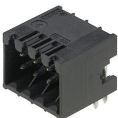
Термостойкий двухрядный вилочный разъем, пригодный для всех распространенных способов пайки. Оптимизирован для автоматической сборки. Упаковка в коробки или в ленту. Контактные штырьки длиной 3,2 mm пригодны для пайки по технологии Reflow и пайки волной. Разъемы снабжены местом для маркировки, а также они могут быть кодированы.
