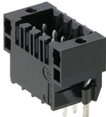
Термостойкий двухрядный штекерный соединитель для всех распространенных методов пайки. Оптимизирован для автоматического монтажа. Упаковка — коробка или лента. Длина выводов 3,2 мм, подходит для пайки волной припоя и оплавлением сквозных отверстий (Reflow). Штекерные разъемы обеспечивают место для маркировки и допускают кодирование.
