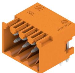
Угловой двухрядный вилочный разъем в следующих исполнениях: боковая сторона закрыта или с фланцем (вилочные разъемы с открытой боковой стороной по запросу). Вилочные разъемы с контактными штырьками длиной 3,5 мм рассчитаны для пайку волной, упаковка - коробки. Возможно резьбовое соединение с печатной платой. Разъемы снабжены местом для маркировки, а также они могут быть кодированы.
