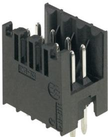
Термостойкий двухрядный штекерный соединитель для всех распространенных методов пайки. Оптимизирован для автоматического монтажа. Упаковка — коробка или лента. Длина выводов 3,2 мм, подходит для пайки волной припоя и оплавлением сквозных отверстий (Reflow). Штекерные разъемы обеспечивают место для маркировки и допускают кодирование.
