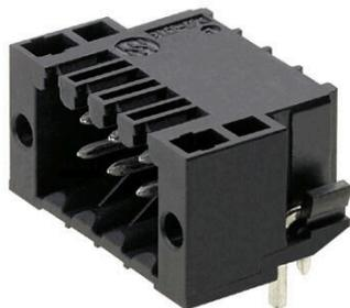
Термостойкий двухрядный вилочный разъем, пригодный для всех распространенных способов пайки. Оптимизирован для автоматической сборки. Упаковка в коробки или в ленту. Контактные штырьки длиной 3,2 мм пригодны для пайки по технологии Reflow и пайки волной. Разъемы снабжены местом для маркировки, а также они могут быть кодированы.
