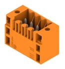
Прямой, двухрядный штекерный соединитель, предлагаемый в вариантах исполнения с закрытыми сторонами или с фланцем (вариант исполнения с открытыми сторонами — по запросу). Штекерные соединители с длиной вывода 3,50 мм предназначены для пайки волной припоя и упакованы в коробку. Допускают монтаж винтами на печатную плату. Штекерные соединители обеспечивают место для маркировки и допускают кодирование.
