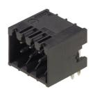
Термостойкий двухрядный вилочный разъем, пригодный для всех распространенных способов пайки. Оптимизирован для автоматической сборки. Упаковка в коробки или в ленту. Контактные штырьки длиной 3,2 мм пригодны для пайки по технологии Reflow и пайки волной. Разъемы снабжены местом для маркировки, а также они могут быть кодированы.
