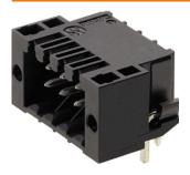
Термостойкий двухрядный вилочный разъем, пригодный для всех распространенных способов пайки. Оптимизирован для автоматической сборки. Упаковка в коробки или в ленту. Контактные штырьки длиной 3,2 мм пригодны для пайки по технологии Reflow и пайки волной. Разъемы снабжены местом для маркировки, а также они могут быть кодированы.
