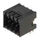
Термостойкий двухрядный вилочный разъем, пригодный для всех распространенных способов пайки. Оптимизирован для автоматической сборки. Упаковка в коробки или в ленту. Контактные штырьки длиной 3,2 мм пригодны для пайки по технологии Reflow и пайки волной. Разъемы снабжены местом для маркировки, а также они могут быть кодированы.
