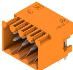
Угловой двухрядный вилочный разъем в следующих исполнениях: боковая сторона закрыта или с фланцем (вилочные разъемы с открытой боковой стороной по запросу). Вилочные разъемы с контактными штырьками длиной 3,5 мм рассчитаны для пайку волной, упаковка - коробки. Возможно резьбовое соединение с печатной платой. Разъемы снабжены местом для маркировки, а также они могут быть кодированы.
