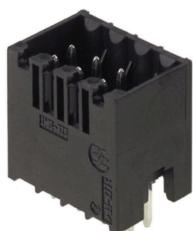
Термостойкий двухрядный штекерный соединитель для всех распространенных методов пайки. Оптимизирован для автоматического монтажа. Упаковка — коробка или лента. Длина выводов 3,2 мм, подходит для пайки волной припоя и оплавлением сквозных отверстий (Reflow). Штекерные разъемы обеспечивают место для маркировки и допускают кодирование.
