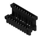
Термостойкий, двухуровневый, с боковым смещением, вилочный разъем с фланцем или фланцем под пайку. Контактные штифты длиной 1,5 мм пригодны для пайки по технологии Reflow. Контактные штырьки длиной 3,2 мм пригодны для пайки по технологии Reflow и пайки волной. Разъемы снабжены местом для маркировки, а также они могут быть кодированы.
