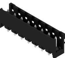
Термостойкий открытый штекерный соединитель прямой конфигурации. Упаковка — коробка или лента. На ленте и с выводами под пайку 1,5 мм оптимизирован для автоматического монтажа. Длина выводов 3,2 мм подходит для пайки волной припоя и оплавлением сквозных отверстий (Reflow). Штекерные соединители обеспечивают место для маркировки и допускают кодирование. HC = сильноточный.
