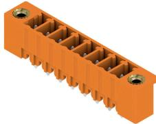
Вилочный разъем SC характеризуется направлением вставки, перпендикулярным печатной плате (вертикально), и доступен в закрытом исполнении (G), а также с винтовым фланцем (F). Соединительные разъемы компании Weidmüller с шагом 3,81 мм (0,15 дюйма) по компоновке совместимы со стандартными соединительными разъемами, снабженны местом для надписей, где может быть нанесена кодировка.
