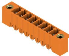
Вилочный разъем SC характеризуется направлением вставки, перпендикулярным печатной плате (вертикально), и доступен в закрытом исполнении (G), а также с винтовым фланцем (F). Соединительные разъемы компании Weidmüller с шагом 3,81 мм (0,15 дюйма) по компоновке совместимы со стандартными соединительными разъемами, снабженны местом для надписей, где может быть нанесена кодировка.
