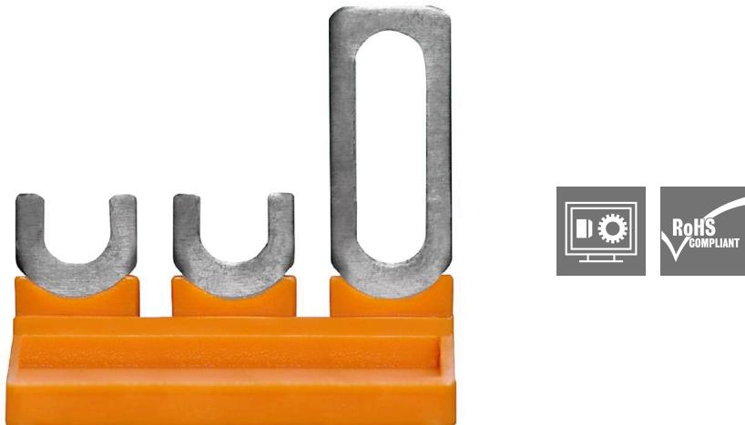
Распределение или умножение потенциала среди смежных клеммных блоков реализуется через перемычку. Это позволяет избежать дополнительных усилий при монтаже. Надежность контакта в клеммных блоках гарантирована даже при разветвлении полюсов. В нашем ассортименте представлены вставные и привинчиваемые винтовые системы перемычек для модульных клеммных блоков.
