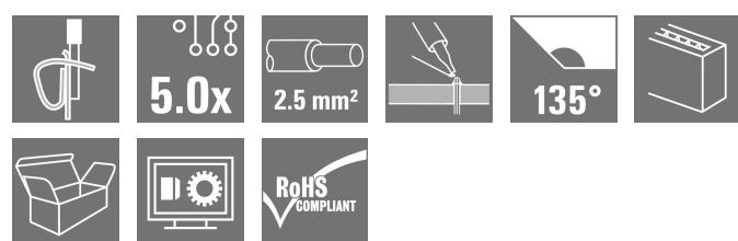
Компактная установочная клемма для проводов с распространенным поперечным сечением 2,5 мм<sup>2</sup>. Пружинное соединение, с направлением вывода провода под углом 135°, с различными величинами шага 5,00-5,08 мм (1 компонент = 2 шага). Номинальные данные:
