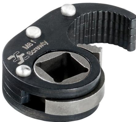
Принадлежность Screwty® подходит для цилиндрических вставных разъемов M8 (для сборки заказчиком) с наружным размером гайки с накаткой  $11,9 \pm 0,3$  мм. Момент затяжки составляет 0,5–0,6 Нм.
