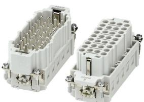
Серия НЕЕ отличается высокой плотностью контактов и разработана на основе созданных вставок НЕ. Уровень подключения проводника спроектирован как контакт PUSH IN. Количество полюсов: 10–64 Номинальный ток: 16 А Номинальное напряжение: 500 В
