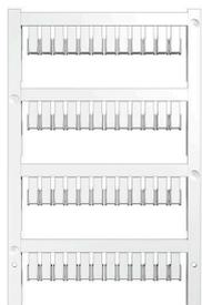
Маркировочные элементы ZS в проверенном формате MultiCard разработаны специально для серии Z. Они отличаются большой областью печати. Откидной механизм обеспечивает доступ к переключкам без демонтажа. Быстрота установки обусловлена тем, что отдельные этикетки защелкиваются в планках. Отдельные этикетки легко отделяются.
