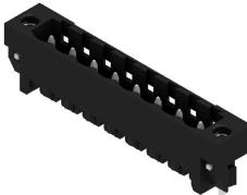
Термостойкий штекерный соединитель, упаковка — коробка или лента. На ленте и с выводами под пайку 1,5 мм оптимизирован для автоматического монтажа. Длина выводов 3,2 мм подходит для пайки волной припоя и оплавлением сквозных отверстий (Reflow). Штекерные соединители обеспечивают место для маркировки и допускают кодирование. HC = сильноточный.
