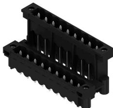
Термостойкий, двухуровневый, с боковым смещением, вилочный разъем с фланцем или фланцем под пайку. Контактные штифты длиной 1,5 мм пригодны для пайки по технологии Reflow. Контактные штырьки длиной 3,2 мм пригодны для пайки по технологии Reflow и пайки волной. Разъемы снабжены местом для маркировки, а также они могут быть кодированы.
