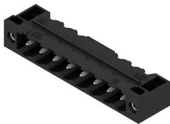
Термостойкий штекерный соединитель, упаковка — коробка или лента. На ленте и с выводами под пайку 1,5 мм оптимизирован для автоматического монтажа. Длина выводов 3,2 мм подходит для пайки волной припоя и оплавлением сквозных отверстий (Reflow). Штекерные соединители обеспечивают место для маркировки и допускают кодирование. HC = сильноточный.
