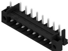
Термостойкий открытый штекерный соединитель прямой конфигурации. Упаковка — коробка или лента. На ленте и с выводами под пайку 1,5 мм оптимизирован для автоматического монтажа. Длина выводов 3,2 мм подходит для пайки волной припоя и оплавлением сквозных отверстий (Reflow). Штекерные соединители обеспечивают место для маркировки и допускают кодирование. НС = сильноточный.
