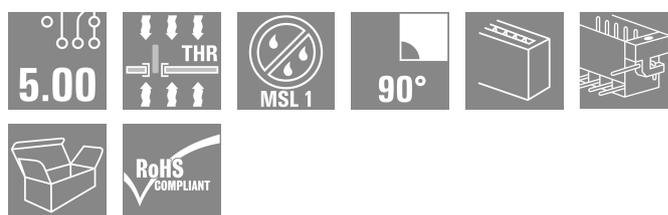
Термостойкий штекерный соединитель, упаковка — коробка или лента. На ленте и с выводами под пайку 1,5 мм оптимизирован для автоматического монтажа. Длина выводов 3,2 мм подходит для пайки волной припоя и оплавлением сквозных отверстий (Reflow). Штекерные соединители обеспечивают место для маркировки и допускают кодирование. HC = высокоточный.
