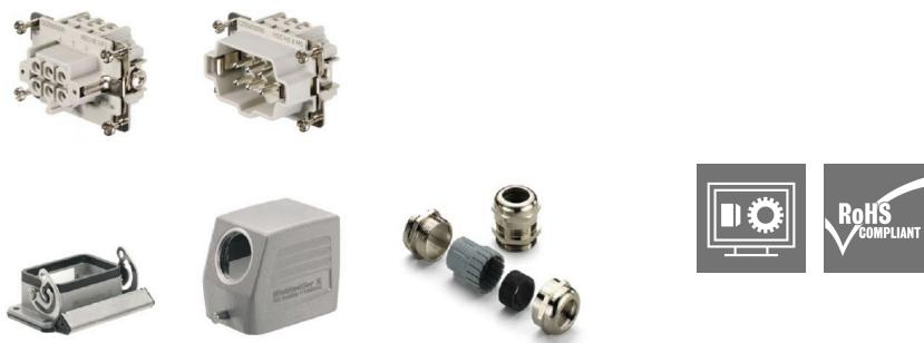
Комплекты HDC – это стандартизованные наборы для изготовления соединительного разъема в сборе. Комплекты HDC, как правило, состоят из вилочной вставки, розеточной вставки, корпуса вилки, проходного корпуса и кабельного ввода.
