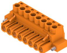
Гнездовой разъем с винтовой системой с зажимным хомутом для подключения проводов с прямым (180°) направлением выводов. Гнездовые разъемы обеспечивают место для маркировки и допускают кодирование. Крепление осуществляется с помощью фланца или фиксатора. Кроме того, они оснащены встроенным винтом с двумя шлицами (прямым и крестообразным), защищкой от неправильной вставки провода и поставляются с открытыми зажимными хомутами. HC = сильноточный.
