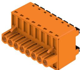
Эффективная топология типа "гирлянда" для мощных сигнальных шин подходит также для вспомогательных силовых цепей с напряжением 400 В с допустимой токовой нагрузкой 18,5 А. Большой диапазон сечений зажимаемых проводов, до 2,5 mm<sup>2</sup>, вследствие малого падения напряжения обеспечивает особые преимущества при длинных шинах или сильных токах. 4 варианта фланцев, включая запатентованный фиксатор, обеспечивают блокировку, учитывающую потребности пользователя.
