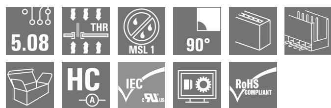
Термостойкий открытый штекерный соединитель угловой конфигурации (90°). Упаковка — коробка или лента. На ленте и с выводами под пайку 1,5 мм оптимизирован для автоматического монтажа. Длина выводов 3,2 мм подходит для пайки волной припоя и оплавлением сквозных отверстий (Reflow). Штекерные соединители обеспечивают место для маркировки и допускают кодирование. HC = сильноточный.
