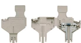
Компонентный штекер служит для интеграции электрического компонента в расцепляющий клеммный блок. После пайки электронного компонента вставку можно интегрировать в расцепляющую зону расцепляющих клеммных блоков, тем самым преобразуя расцепляющий клеммный блок в модульный клеммный блок с интегрированным электронным компонентом.
