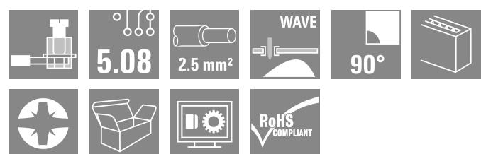
Одно- и многорядная клемма для печатной платы с проверенным на практике винтовым соединением и шагом 5,08 мм. Для проводов сечением до 2,5 мм<sup>2</sup>.
