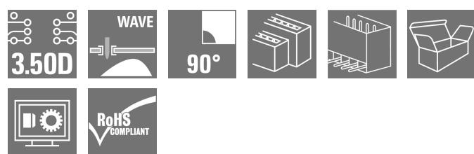
Угловой двухрядный вилочный разъем в следующих исполнениях: боковая сторона закрыта или с фланцем (вилочные разъемы с открытой боковой стороной по запросу). Вилочные разъемы с контактными штырьками длиной 3,5 мм рассчитаны для пайку волнной, упаковка - коробки. Возможно резьбовое соединение с печатной платой. Разъемы снабжены местом для маркировки, а также они могут быть кодированы.
