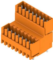
Двухуровневый, ступенчатый штекерный соединитель для пайки волной припоя с шагом 3,50 mm. Предлагаемые варианты исполнения: закрытый и с фланцем. Штекерные разъемы обеспечивают место для маркировки и допускают кодирование.
