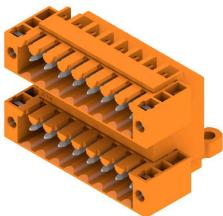
Двухуровневый штекерный соединитель для пайки волной припоя с шагом 3,50 mm. Варианты исполнения соединителя: открытый, закрытый и с фланцем. Штекерные разъемы обеспечивают место для маркировки и допускают кодирование. Упаковка — картонная коробка.
