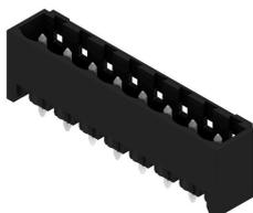
Термостойкий штекерный соединитель, упаковка — коробка или лента. На ленте и с выводами под пайку 1,5 мм оптимизирован для автоматического монтажа. Длина выводов 3,2 мм подходит для пайки волной припоя и оплавлением сквозных отверстий (Reflow). Штекерные соединители обеспечивают место для маркировки и допускают кодирование. HC = высокоточный.
