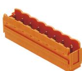
Вилочные разъемы с прямым выводом проводов под углом 180°. Длина контактного штырька оптимизирована под пайку волной. Разъемы снабжены местом для маркировки, а также они могут быть кодированы.
