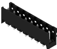
Термостойкий открытый штекерный соединитель прямой конфигурации. Упаковка — коробка или лента. На ленте с выводами под пайку 1,5 мм оптимизирован для автоматического монтажа. Длина выводов 3,2 мм подходит для пайки волной припоя и оплавлением сквозных отверстий (Reflow). Штекерные соединители обеспечивают место для маркировки и допускают кодирование. HC = сильноточный.
