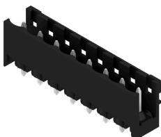
Термостойкий открытый штекерный соединитель прямой конфигурации. Упаковка — коробка или лента. На ленте и с выводами под пайку 1,5 mm оптимизирован для автоматического монтажа. Длина выводов 3,2 mm подходит для пайки волной припоя и оплавлением сквозных отверстий (Reflow). Штекерные соединители обеспечивают место для маркировки и допускают кодирование. HC = сильноточный.
