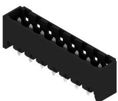
Термостойкий штекерный соединитель, упаковка — коробка или лента. На ленте и с выводами под пайку 1,5 mm оптимизирован для автоматического монтажа. Длина выводов 3,2 mm подходит для пайки волной припоя и оплавлением сквозных отверстий (Reflow). Штекерные соединители обеспечивают место для маркировки и допускают кодирование. HC = сильноточный.
