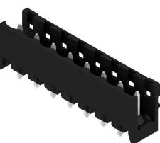
Термостойкий открытый штекерный соединитель прямой конфигурации. Упаковка — коробка или лента. На ленте и с выводами под пайку 1,5 мм оптимизирован для автоматического монтажа. Длина выводов 3,2 мм подходит для пайки волной припоя и оплавлением сквозных отверстий (Reflow). Штекерные соединители обеспечивают место для маркировки и допускают кодирование. НС = сильноточный.
