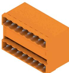
Двухуровневый вилочный разъем с параллельным разъемом. Длина контактного штырька оптимизирована под пайку волной. Разъемы снабжены местом для маркировки, а также они могут быть кодированы.
