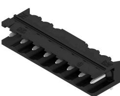
Термостойкий открытый штекерный соединитель угловой конфигурации (90°). Упаковка — коробка или лента. На ленте и с выводами под пайку 1,5 мм оптимизирован для автоматического монтажа. Длина выводов 3,2 мм подходит для пайки волной припоя и оплавлением сквозных отверстий (Reflow). Штекерные соединители обеспечивают место для маркировки и допускают кодирование. НС = сильноточный.
