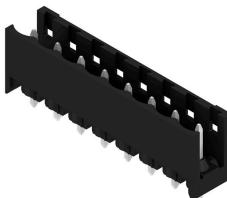
Термостойкий открытый штекерный соединитель прямой конфигурации. Упаковка — коробка или лента. На ленте и с выводами под пайку 1,5 мм оптимизирован для автоматического монтажа. Длина выводов 3,2 мм подходит для пайки волной припоя и оплавлением сквозных отверстий (Reflow). Штекерные соединители обеспечивают место для маркировки и допускают кодирование. НС = сильноточный.
