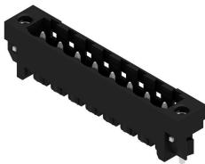
Термостойкий штекерный соединитель, упаковка — коробка или лента. На ленте и с выводами под пайку 1,5 mm оптимизирован для автоматического монтажа. Длина выводов 3,2 mm подходит для пайки волной припоя и оплавлением сквозных отверстий (Reflow). Штекерные соединители обеспечивают место для маркировки и допускают кодирование. HC = сильноточный.
