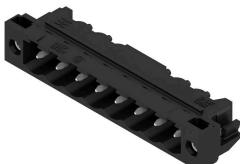
Термостойкий штекерный соединитель, упаковка — коробка или лента. На ленте и с выводами под пайку 1,5 мм оптимизирован для автоматического монтажа. Длина выводов 3,2 мм подходит для пайки волной припоя и оплавлением сквозных отверстий (Reflow). Штекерные соединители обеспечивают место для маркировки и допускают кодирование. HC = сильноточный.
