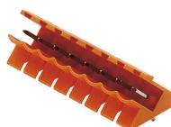
Вилочные разъемы с выводом провода под углом 135°. Длина контактного штырька оптимизирована под пайку волной. Разъемы снабжены местом для маркировки, а также они могут быть кодированы.
