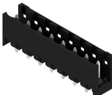
Термостойкий открытый штекерный соединитель прямой конфигурации. Упаковка — коробка или лента. На ленте и с выводами под пайку 1,5 мм оптимизирован для автоматического монтажа. Длина выводов 3,2 мм подходит для пайки волной припоя и оплавлением сквозных отверстий (Reflow). Штекерные соединители обеспечивают место для маркировки и допускают кодирование. HC = сильноточный.
