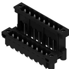
Термостойкий, двухуровневый, с боковым смещением, вилочный разъем с фланцем или фланцем под пайку. Контактные штифты длиной 1,5 мм пригодны для пайки по технологии Reflow. Контактные штырьки длиной 3,2 мм пригодны для пайки по технологии Reflow и пайки волной. Разъемы снабжены местом для маркировки, а также они могут быть кодированы.
