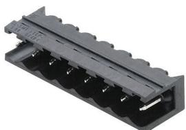
Термостойкий открытый штекерный соединитель прямой конфигурации. Упаковка — коробка или лента. На ленте и с выводами под пайку 1,5 мм оптимизирован для автоматического монтажа. Длина выводов 3,2 мм подходит для пайки волной припоя и оплавлением сквозных отверстий (Reflow). Штекерные соединители обеспечивают место для маркировки и допускают кодирование. HC = сильноточный.
