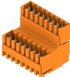
Двухуровневый, ступенчатый штекерный соединитель для пайки волной припоя с шагом 3,50 мм. Предлагаемые варианты исполнения: закрытый и с фланцем. Штекерные разъемы обеспечивают место для маркировки и допускают кодирование.
