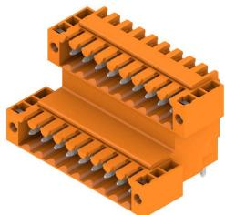
Двухуровневый, ступенчатый штекерный соединитель для пайки волной припоя с шагом 3,50 mm. Предлагаемые варианты исполнения: закрытый и с фланцем. Штекерные разъемы обеспечивают место для маркировки и допускают кодирование.
