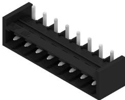
Термостойкий открытый штекерный соединитель прямой конфигурации. Упаковка — коробка или лента. На ленте и с выводами под пайку 1,5 мм оптимизирован для автоматического монтажа. Длина выводов 3,2 мм подходит для пайки волной припоя и оплавлением сквозных отверстий (Reflow). Штекерные соединители обеспечивают место для маркировки и допускают кодирование. НС = сильноточный.
