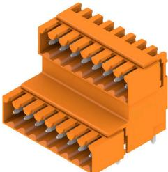
Двухуровневый, ступенчатый штекерный соединитель для пайки волной припоя с шагом 3,50 мм. Предлагаемые варианты исполнения: закрытый и с фланцем. Штекерные разъемы обеспечивают место для маркировки и допускают кодирование.
