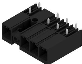
Штекерный соединитель 270° со средним фланцем с шагом 7,62. Соответствует требованиям IEC 61800-5-1 и допускает сертификацию UL согласно UL840 600 В. Без гнездового соединителя профиль сочленения гарантирует минимальную безопасность при касании >3 мм при давлении 20 Н на испытательном пальце. Автоматически блокирующий средний фланец, который может быть завинчен, уменьшает необходимое место на один шаг по ширине по сравнению с обычными решениями.
