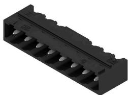
Термостойкий штекерный соединитель, упаковка — коробка или лента. На ленте и с выводами под пайку 1,5 мм оптимизирован для автоматического монтажа. Длина выводов 3,2 мм подходит для пайки волной припоя и оплавлением сквозных отверстий (Reflow). Штекерные соединители обеспечивают место для маркировки и допускают кодирование. HC = высокоточный.
