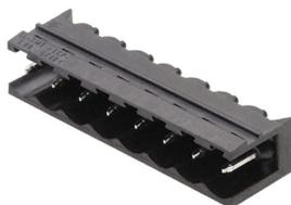
Термостойкий открытый штекерный соединитель прямой конфигурации. Упаковка — коробка или лента. На ленте и с выводами под пайку 1,5 мм оптимизирован для автоматического монтажа. Длина выводов 3,2 мм подходит для пайки волной припоя и оплавлением сквозных отверстий (Reflow). Штекерные соединители обеспечивают место для маркировки и допускают кодирование. HC = высокоточный.
