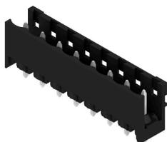
Термостойкий открытый штекерный соединитель прямой конфигурации. Упаковка — коробка или лента. На ленте и с выводами под пайку 1,5 мм оптимизирован для автоматического монтажа. Длина выводов 3,2 мм подходит для пайки волной припоя и оплавлением сквозных отверстий (Reflow). Штекерные соединители обеспечивают место для маркировки и допускают кодирование. HC = высокоточный.
