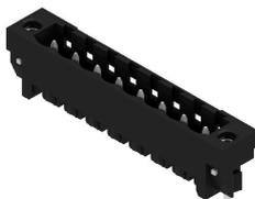
Термостойкий штекерный соединитель, упаковка — коробка или лента. На ленте и с выводами под пайку 1,5 мм оптимизирован для автоматического монтажа. Длина выводов 3,2 мм подходит для пайки волной припоя и оплавлением сквозных отверстий (Reflow). Штекерные соединители обеспечивают место для маркировки и допускают кодирование. HC = высокоточный.
