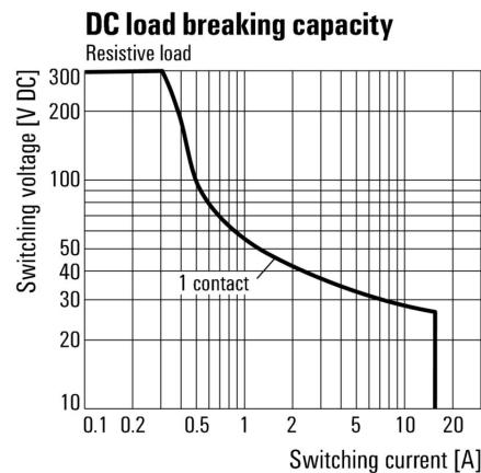
Кривая предельной нагрузки
