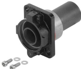
Защитный корпус изготовлен из стойкого к морской воде алюминия методом литья под давлением. Высокие стандарты водо- и пылезащиты, а также чрезвычайно высокая ударостойкость являются отличительными признаками корпусов данной серии. Современное двухэтапное покрытие поверхности обеспечивает многолетнюю надежность. Все винты, обжимные контакты и другие наружные детали принадлежностей изготовлены из коррозионностойкой нержавеющей стали.
