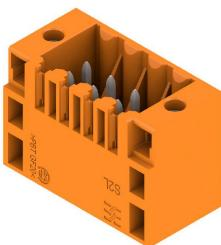
Прямой, двухрядный штекерный соединитель, предлагаемый в вариантах исполнения с закрытыми сторонами или с фланцем (вариант исполнения с открытыми сторонами — по запросу). Штекерные соединители с длиной вывода 3,50 mm предназначены для пайки волной припоя и упакованы в коробку. Допускают монтаж винтами на печатную плату. Штекерные соединители обеспечивают место для маркировки и допускают кодирование.
