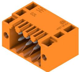
Угловой двухрядный вилочный разъем в следующих исполнениях: боковая сторона закрыта или с фланцем (вилочные разъемы с открытой боковой стороной по запросу). Вилочные разъемы с контактными штырьками длиной 3,5 мм рассчитаны для пайки волной, упаковка - коробки. Возможно резьбовое соединение с печатной платой. Разъемы снабжены местом для маркировки, а также они могут быть кодированы.
