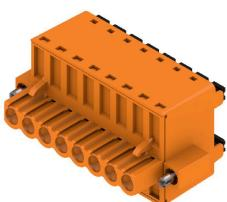
Эффективная топология типа "гирлянда" для мощных сигнальных шин подходит также для вспомогательных силовых цепей с напряжением 400 В с допустимой токовой нагрузкой 18,5 А. Большой диапазон сечений зажимаемых проводов, до 2,5 mm<sup>2</sup>, вследствие малого падения напряжения обеспечивает особые преимущества при длинных шинах или сильных токах. 4 варианта фланцев, включая запатентованный фиксатор, обеспечивают блокировку, учитывающую потребности пользователя.
