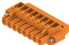
Гнездовые разъемы с соединением с зажимным хомутом для подключения проводов с направлением выводов под прямым углом (90° или 270°). Гнездовые разъемы обеспечивают место для маркировки и допускают кодирование. Крепление осуществляется с помощью фланца или фиксатора. Кроме того, они оснащены встроенным винтом с двумя шлицами (прямым и крестообразным), защитой от неправильной вставки провода и поставляются с открытыми зажимными хомутами. HC = сильноточный.
