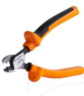
Режущие инструменты для проводников наружным диаметром до 8, 12, 14 и 22 мм. Особая геометрия лезвия обеспечивает резку медных и алюминиевых проводников без пережатия и с минимальным физическим усилием. Режущие инструменты (от KT 8 до KT 22) также поставляются с защитной изоляцией до 1000 В, прошедшей испытания VDE и GS, в соответствии со стандартом EN/ IEC 60900.
