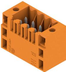
Прямой, двухрядный штекерный соединитель, предлагаемый в вариантах исполнения с закрытыми сторонами или с фланцем (вариант исполнения с открытыми сторонами — по запросу). Штекерные соединители с длиной вывода 3,50 мм предназначены для пайки волной припоя и упакованы в коробку. Допускают монтаж винтами на печатную плату. Штекерные соединители обеспечивают место для маркировки и допускают кодирование.
