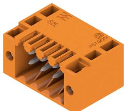
Угловой двухрядный вилочный разъем в следующих исполнениях: боковая сторона закрыта или с фланцем (вилочные разъемы с открытой боковой стороной по запросу). Вилочные разъемы с контактными штырьками длиной 3,5 мм рассчитаны для пайку волной, упаковка - коробки. Возможно резьбовое соединение с печатной платой. Разъемы снабжены местом для маркировки, а также они могут быть кодированы.
