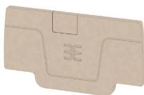
Концевые пластины крепятся к открытой стороне последней клеммы перед концевым стопором. Благодаря использованию концевой пластины обеспечивается работоспособность клеммы и заданное расчетное напряжение. Гарантируется защита от прикосновения к деталям, находящимся под напряжением, и таким образом клеммы безопасны для прикосновения.
