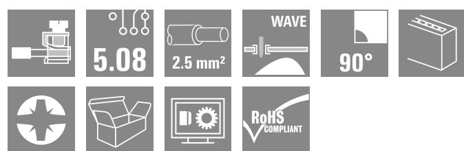
Клемма для печатной платы с соединением с плоской пружиной и шагом 5,00 и 5,08 мм. Направление вывода проводов: 90°. Для проводов сечением до 2,5 мм<sup>2</sup>.
